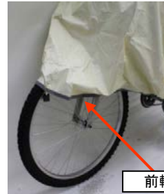
b) ロングポンチヨ②が前輪に接触した例
