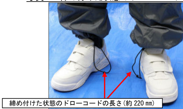
写真 5. 締め付けた状態のドロークコードの長さ
