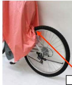
a) ポンチヨ②が後輪に接触した例
